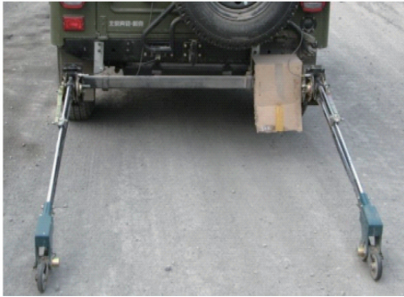
图 5 路面不平度测试仪器及车辆
